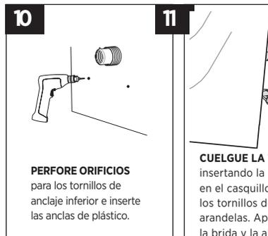
**PERFORE ORIFICIOS** para los tornillos de anclaje inferior e inserte las anclas de plástico.
