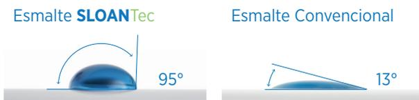
Para asegurar que las propiedades hidrofóbicas y oleofóbicas únicas del esmalte SloanTec fueran permanentes y pudieran hacer frente a las duras condiciones en los cuartos de baño comerciales, realizamos una serie de pruebas para envejecer artificialmente la superficie.
